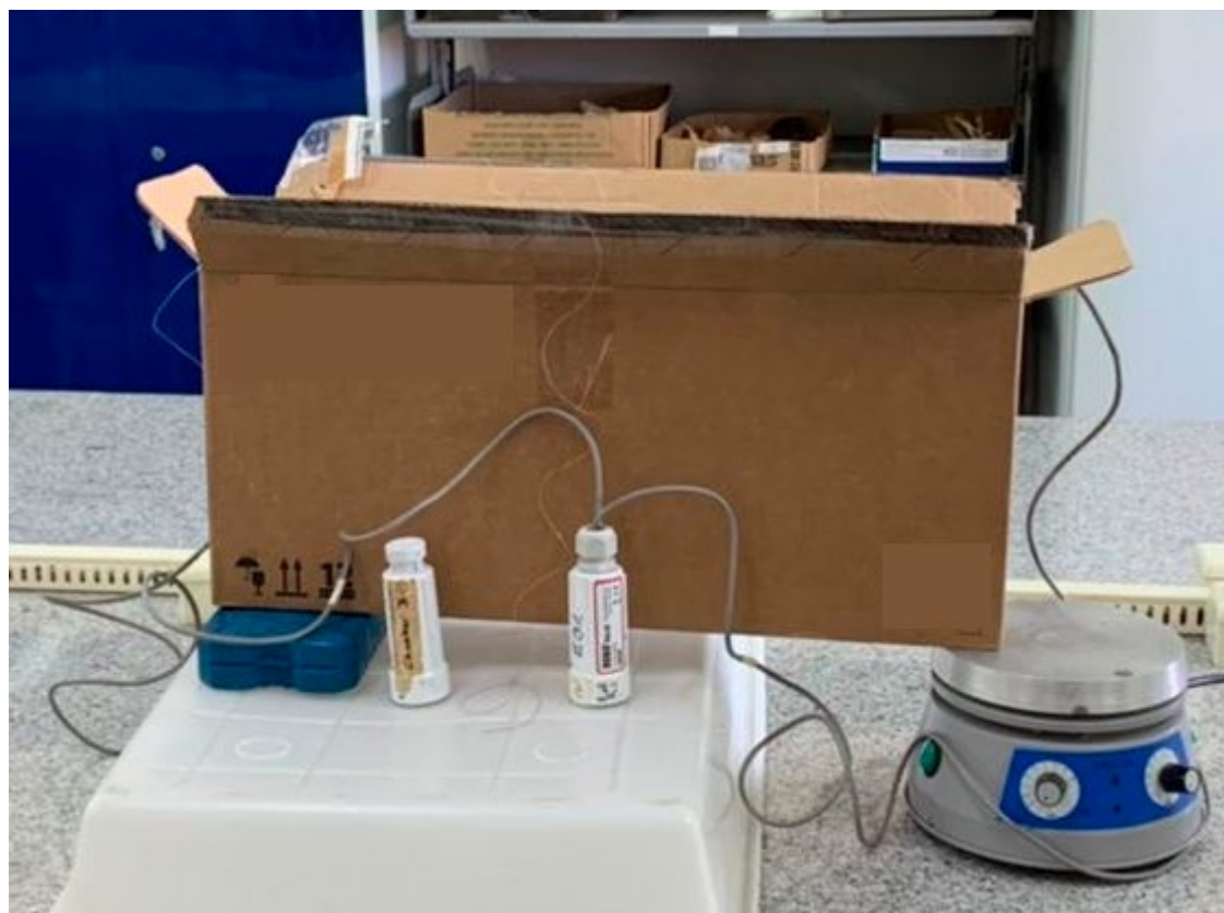
Figura 2. Gradiente termal criado em laboratório utilizando uma caixa de papelão com gelo numa extremidade e um aquecedor por indução na outra.
