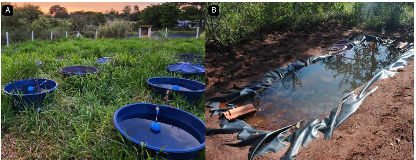
Figura 5. Experimento em mesocosmo: A) caixas d'água de polipropileno e B) lagoa construída por escavação e coberta com manta. As fotos foram fornecidas por Rodolfo Mei Pelinson.
